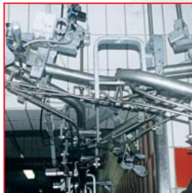
Vollautomatische Ausschleusung aufgebogener Haken
