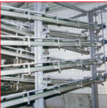
Leerhakenspeicher auf engstem Raum
